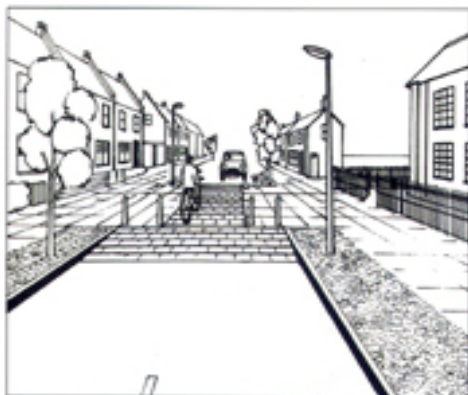
Estrangulamiento de la vía
